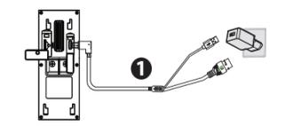
**⚠️ ACHTUNG! Bitte beachten Sie, dass es verboten ist, die Türklingel an AC (Wechselstrom) und USB Typ-C-Spannungsversorgung / Netzteil gleichzeitig anzuschließen.**
