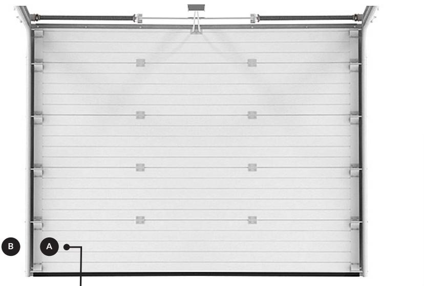
POSIZIONARE IL SENSORE NELLA SEZIONE NELLA PARTE INFERIORE DELLA TUA PORTA.
