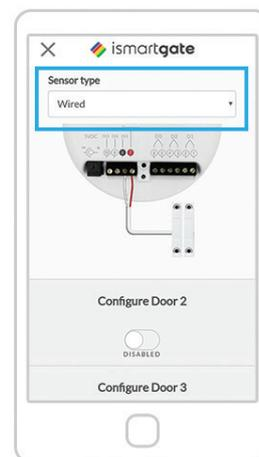
Nella sezione CONFIGURAZIONE "Porta", scegliere il tipo di sensore cablati.
