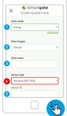
Wählen Sie im Abschnitt "Tür" -KONFIGURATION den Sensortyp Kabellos (ISG-TWS)
