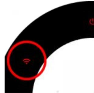
Se dopo 30 secondi, la luce Wi-Fi del dispositivo è ancora rossa, reimposta ismartgate e riprova. Per resettare il dispositivo, vai a pagina 14.
