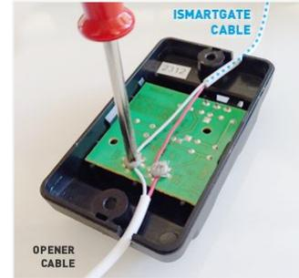
collega le uscite di ismartgate alle viti del pulsante. La polarità non ha importanza. Poi avvita di nuovo.
